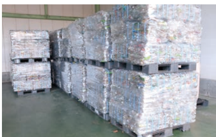
15個を1ユニットとして保管されるベール
