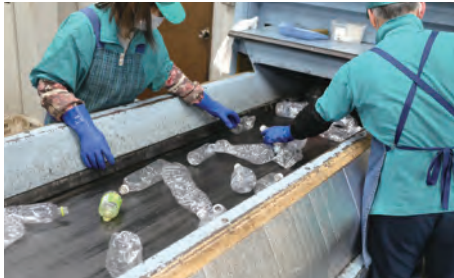
富久山クリーンセンター内の手選別作業
