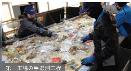
第一工場の手選別工程
