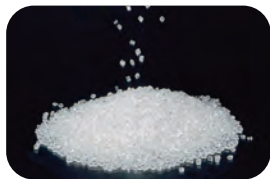
ペレット フレークを加熱融解して 粒状にしたもの
