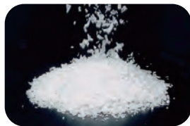
フレーク ボトルを約8mm角に 裁断したもの
