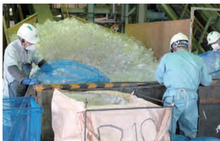
回収PETボトルを最初に選別する受入ホッパ
