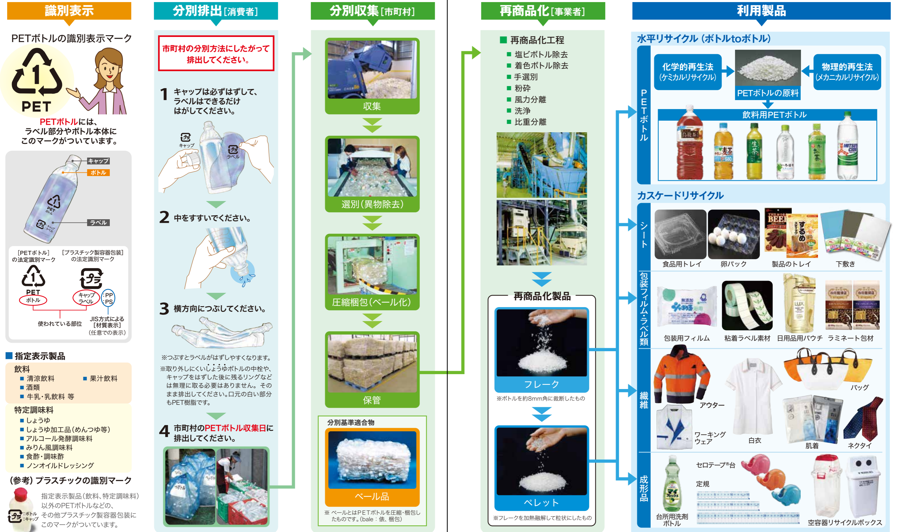
図11. PETボトルリサイクルの流れ
