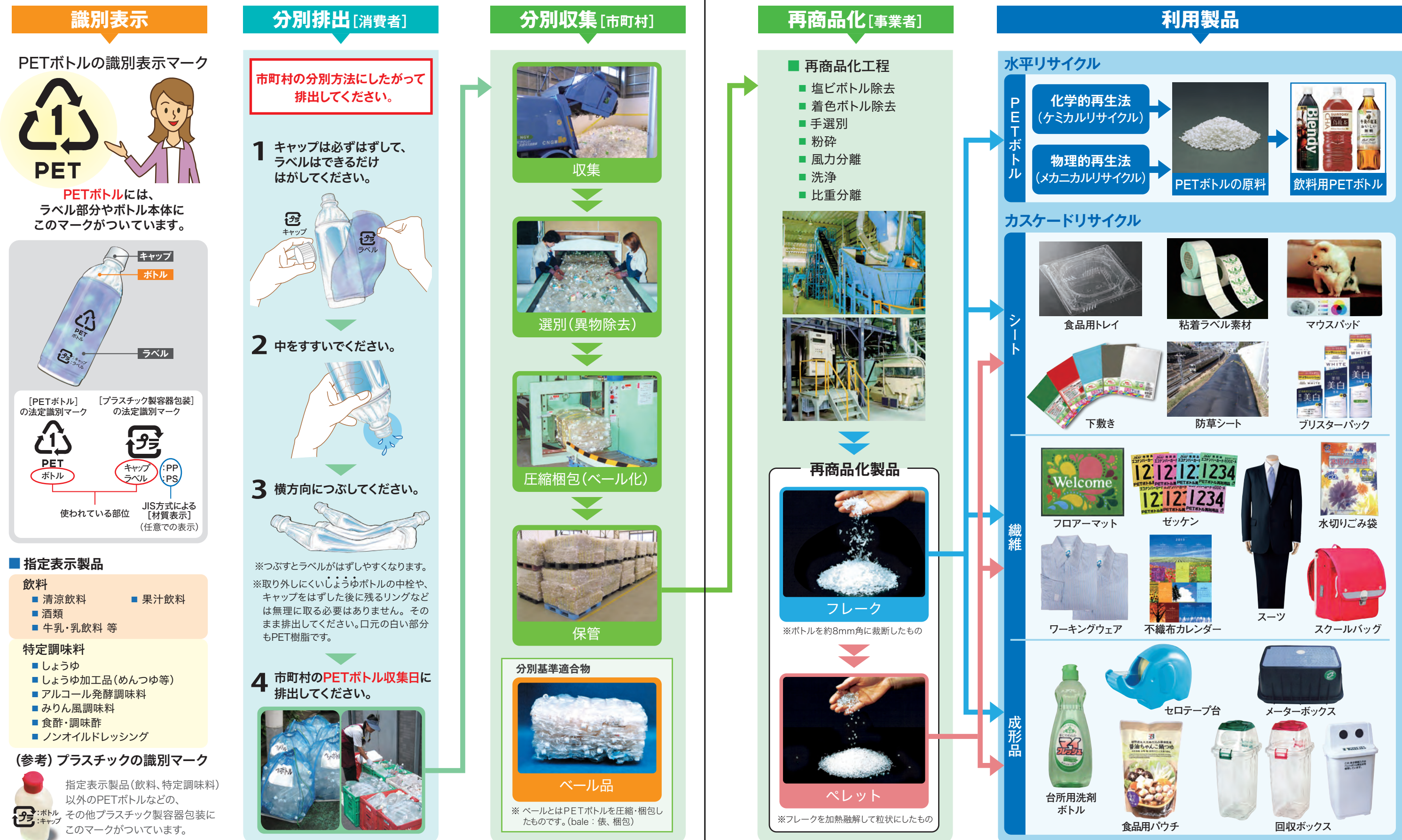
図11. PETボトルリサイクルの流れ
