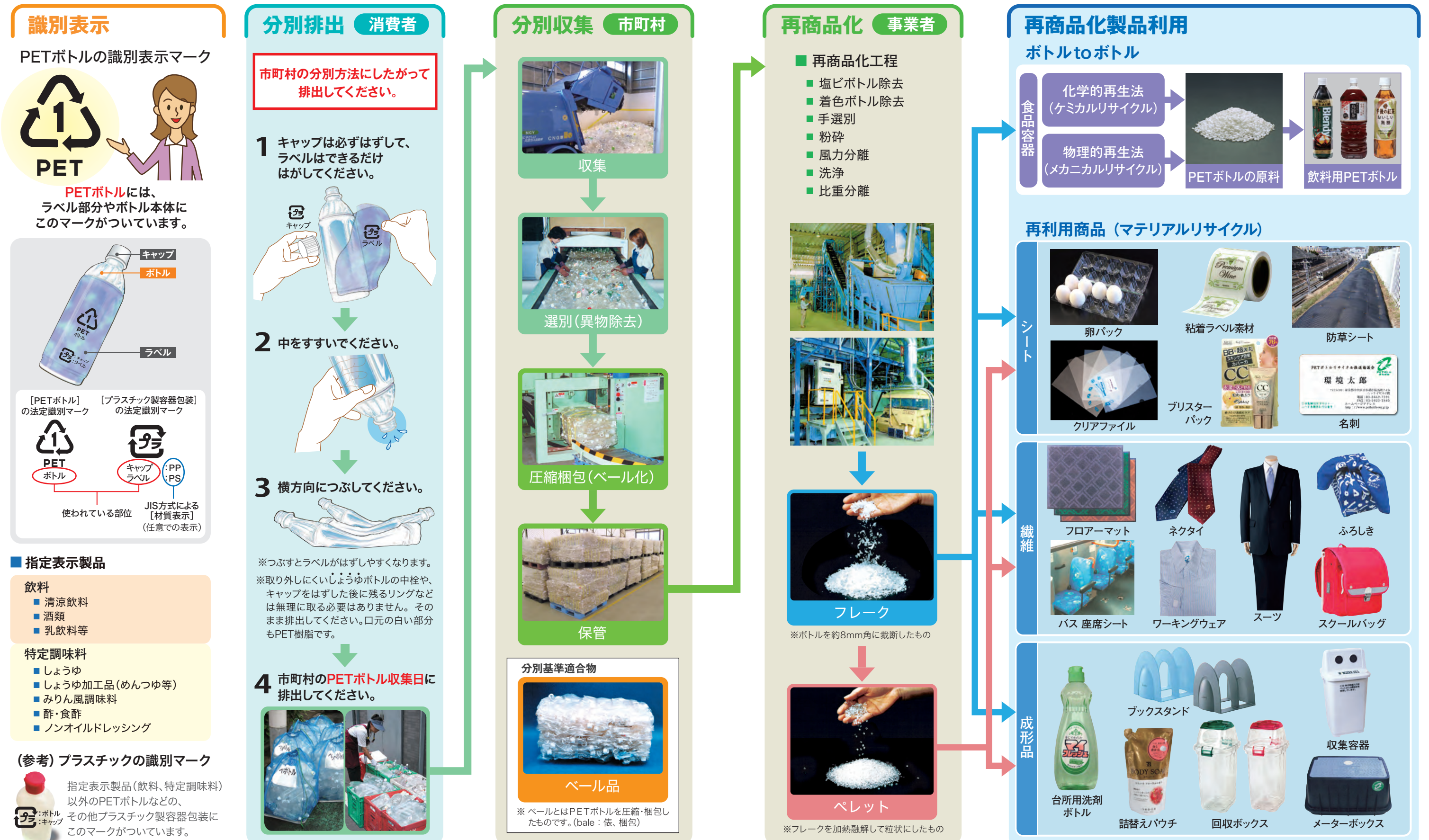
図10. PETボトル再商品化の流れ
